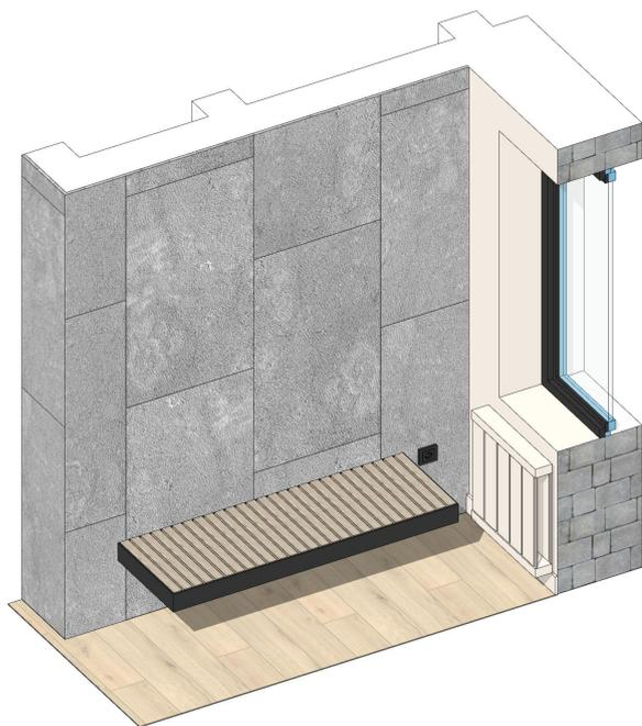
Лавка консольная на стальном каркасе. основание труба 60x30, с торцов предусмотреть окантовку из стального листа 3мм x100 мм. Со всех элементов снять фаску. Окраска порошковая матовая цвет gal7021 Для крепежа каркаса в стене предусмотреть закладные из стальной трубы 60x60 мм. Сидение лавки брусок 40x40 мм массив лиственницы окраска марилка под цвет дуба + лак.
