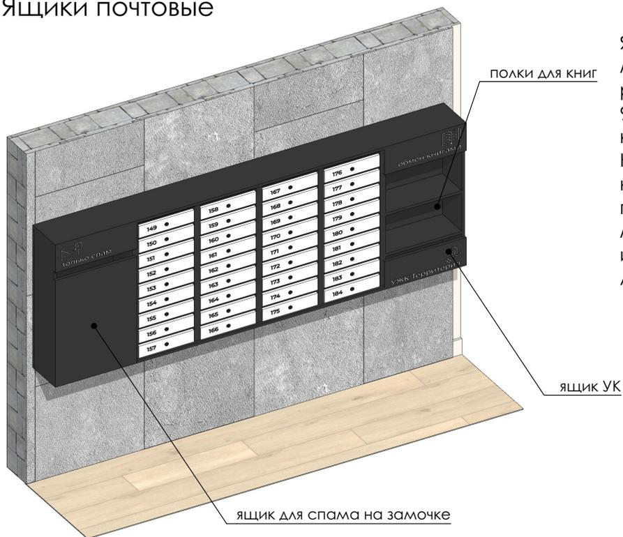
Ящики почтовые из металла, без боковой рамки, цвет дверок ral 9003, цвет основного каркаса ral 7021. Номерки ящиков нанести лазерной печатью. Боковые модули изготавливаются из ЛДСП.
